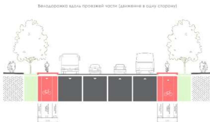
Рисунок 70 – Типовые поперечные профили решения обособленных велопутей сообщения (вариант4)
