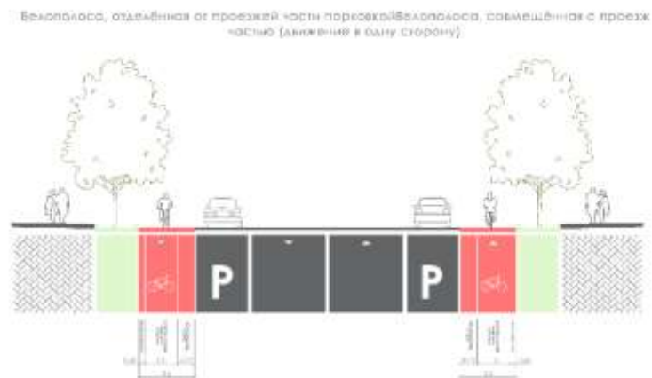
Рисунок 68 – Типовые поперечные профили решения обособленных велопутей сообщения (вариант2)
