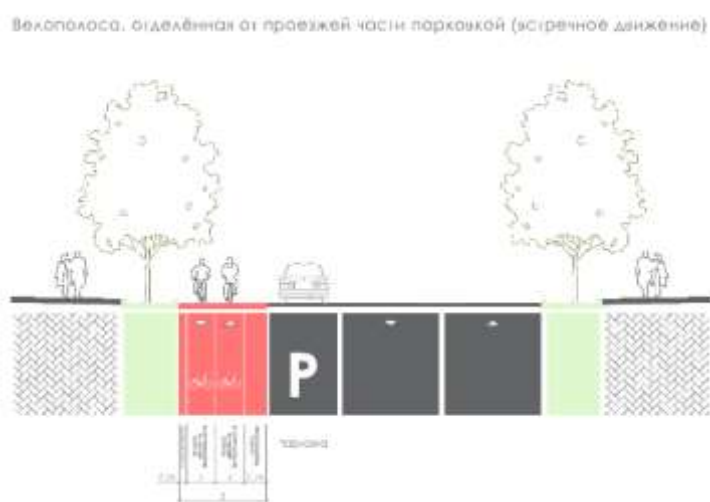
Рисунок 69 – Типовые поперечные профили решения обособленных велопутей сообщения (вариант3)
