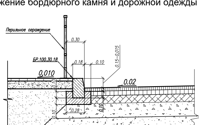
Сопряжение бордюрного камня и дорожной одежды
