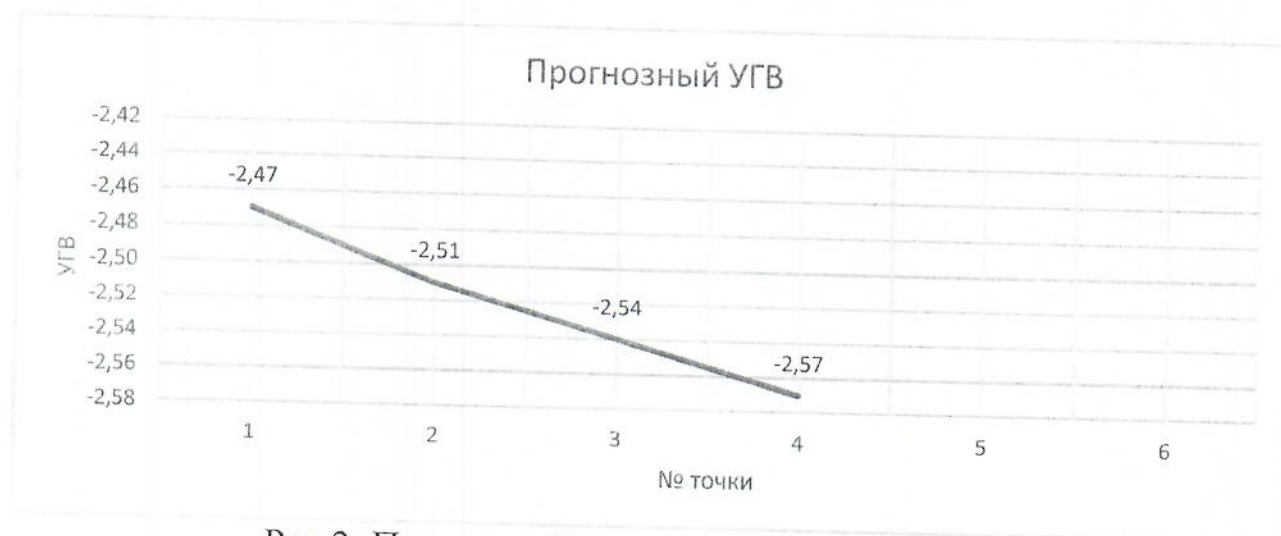
Рис.2- Прогнозный уровень залегания грунтовых вод
